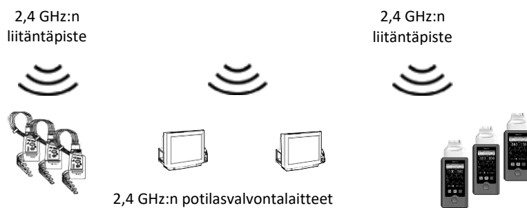
Kuva 1: SMART HOPPING® 2.0 -liitäntäpisteen infrastrukturi
